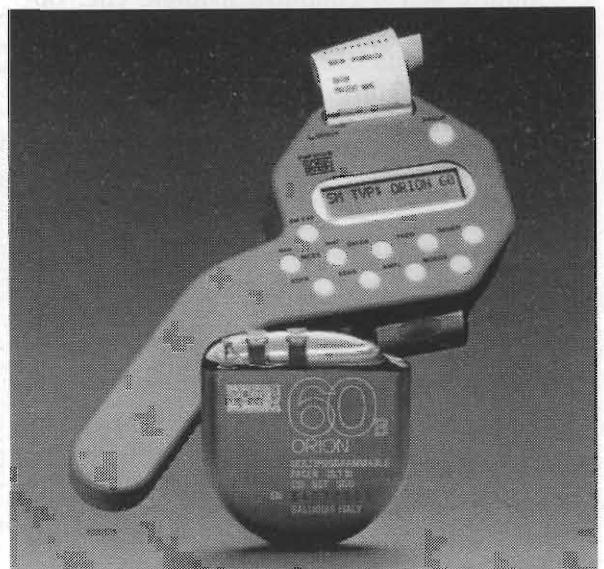
Foto 5 - Sorin multiprogrammabile con programmatore tascabile (con stampante) 1987.
